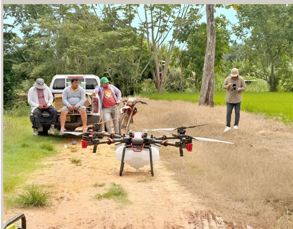
▲ Calibración de las bombas peristálticas del dron XAG modelo P100 Pro. Fuente: Los autores, 2026.
