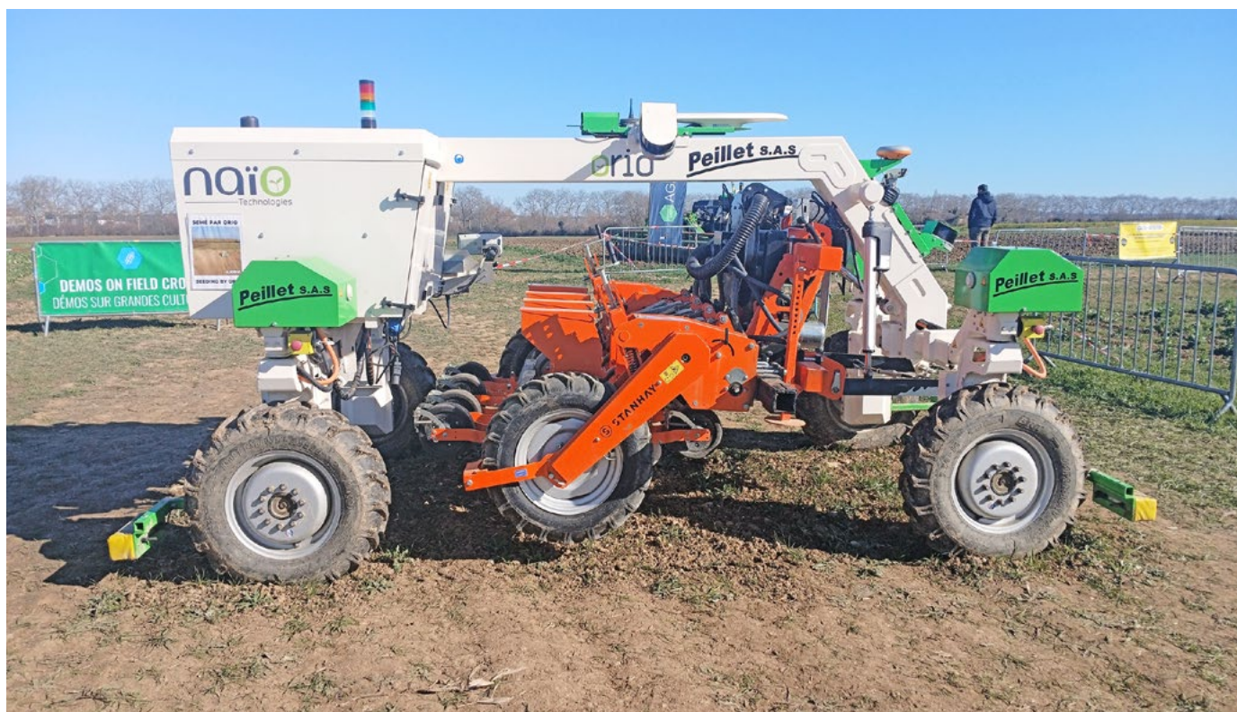
Foto 2. El robot Orio, diseñado específicamente para la siembra precisa de hortalizas. Fuente: El autor, 2025.
