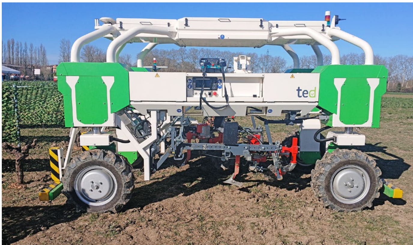
Foto 3. El robot Ted está diseñado para el mantenimiento de cultivo en viñedos. Fuente: El autor, 2025.
