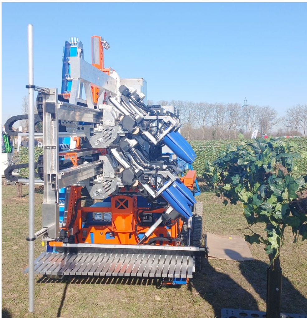
Foto 4. Robot cosechador de uvas diseñado para la producción de vinos de calidad. Fuente: El autor, 2025.
