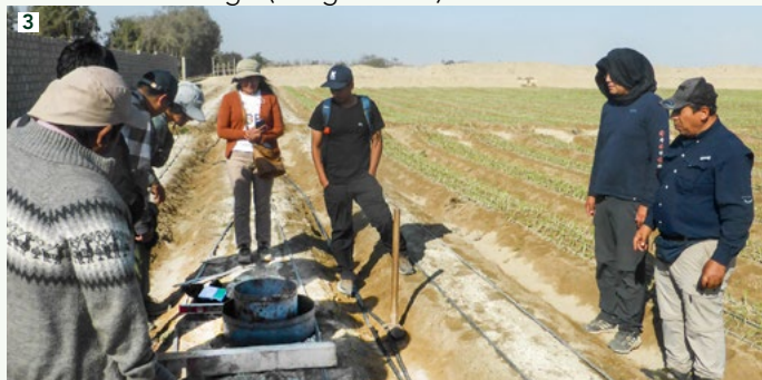
3. Prueba de infiltración del campo experimental
